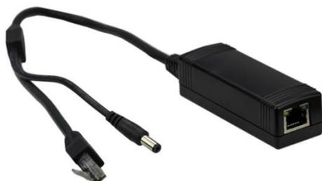
PoE сплиттер, предназначен для разделения питающего напряжения и данных, передаваемых по Ethernet. Разделение PoE линии на линию Ethernet и линию DC 5В. PoE вход IEEE802.3af (до 15,4Вт). Выход DC - 5В до 5Вт и выход Ethernet со скоростью передачи 10/100 Мбит/с. Питание от PoE линии. Защита от перенапряжения. Вес 76г, размеры 88x30x25мм. Пластиковый миниатюрный корпус и кабель.
