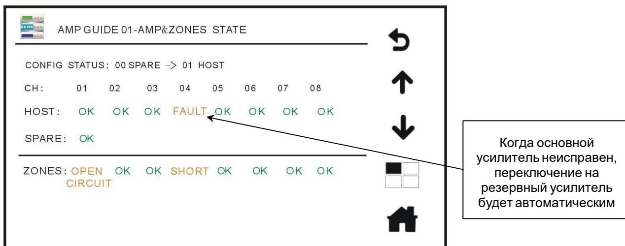
Рис. 4.13. Состояние переключения на резервный усилитель в окне
