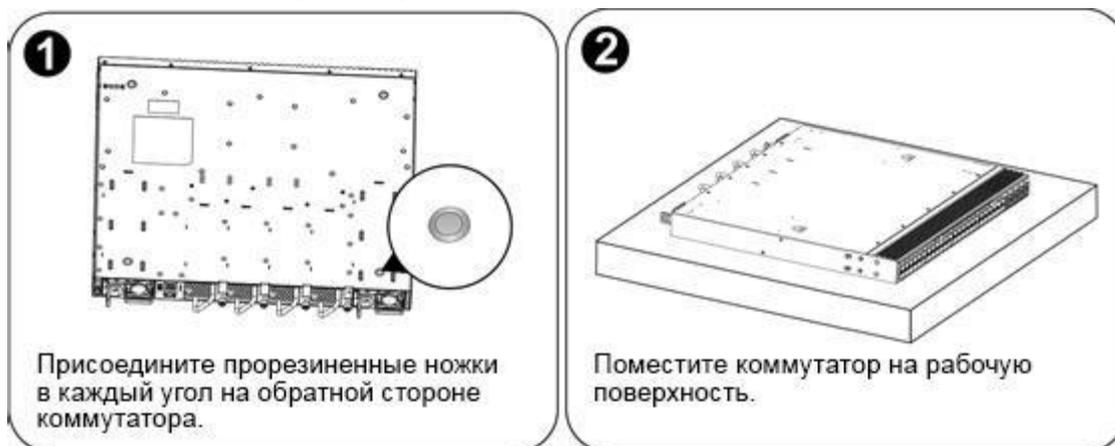
Рисунок 8. Установка коммутатора на рабочее место
